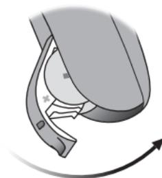
Schließen Sie das Batteriefach vollständig, und überprüfen Sie, ob es gesichert ist.
