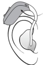
Setzen Sie das Hörsystem hinter das Ohr.
