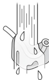
Reinigen Sie die Otoplastik und den Schlauch mit einer milden Seifenlauge. Otoplastik und Schlauch müssen vor dem erneuten Verbinden mit dem Hörsystem gespült werden und vollkommen trocken sein.
