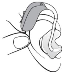
Ziehen Sie das Ohr etwas nach hinten und drücken Sie die Otoplastik unter leichtem Drehen in den Gehörgang.
