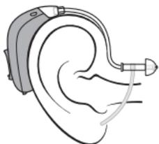
Setzen Sie das Hörsystem hinter das Ohr. Der Dünnschlauch darf nur mit einem angebrachten Ohrstück verwendet werden. Verwenden Sie nur Teile, die speziell für Ihr Hörsystem angefertigt wurden.
