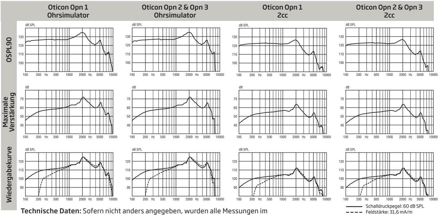
Technische Daten: Sofern nicht anders angegeben, wurden alle Messungen im omnidirektionalen Modus durchgeführt.
