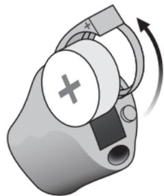
Abra completamente el portapilas. Extraiga la pila.
