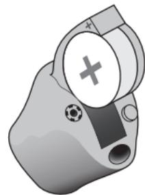
Introduzca la pila nueva en el portapilas. Asegúrese de que la cara + de la pila coincida con el signo + grabado en el portapilas.
