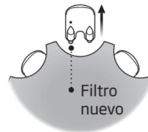
Extraiga la herramienta de la carcasa. La herramienta tiene dos puntas: una vacía para extraer y otra con el filtro ProWax nuevo.
