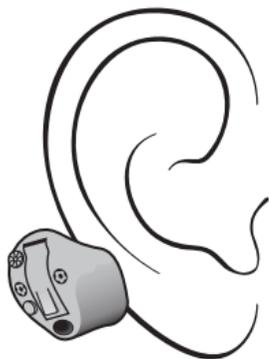
Coja el audífono de forma que el punto de color quede mirando hacia arriba. Coloque la punta del audífono en el conducto auditivo.
