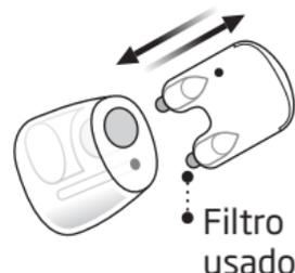
Inserte el filtro nuevo utilizando la otra punta, retire la herramienta y tírela.
