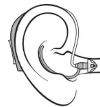
Empuje el cono con cuidado por el conducto auditivo hasta que el cable del altavoz quede encajado junto al lateral de la cabeza.
