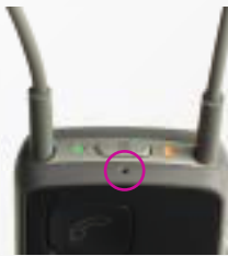
Póngase el Streamer alrededor del cuello y compruebe que el micrófono no se tapa. Asegúrese de que habla directamente a la entrada de sonido.
