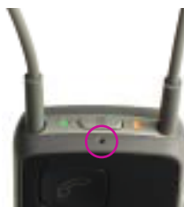
Póngase el Streamer alrededor del cuello y compruebe que el micrófono no se tapa con ninguna prenda. Asegúrese también de que habla directamente a la entrada de sonido del micrófono.
