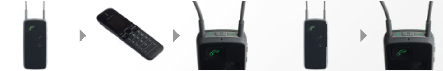
Presione el botón "teléfono" de la parte frontal del Streamer y se encenderá en verde. Oirá el sonido de cambio de programa en los audífonos seguido del tono de llamada indicando que la línea está disponible.
