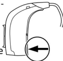
**Cómo desbloquear el portapilas:** Utilice un destornillador pequeño para colocar el tornillo de seguridad en la posición de desbloqueo.
