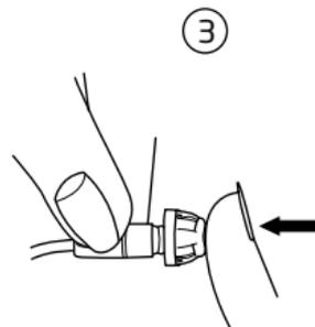
Bajo el cono notará la presencia de un filtro anticerumen blanco en el extremo del auricular. Este filtro evitará que los restos de cerumen dañen al auricular. Si el filtro se tapona, póngase en contacto con su audioprotesista para cambiarlo.
