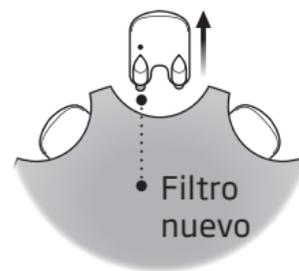
Extraiga la herramienta de la carcasa. La herramienta tiene dos puntas: una vacía para extraer y otra con el filtro anticerumen nuevo.
