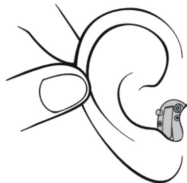
Tire de la oreja hacia atrás e introduzca el audífono en el conducto auditivo, girándolo levemente si es necesario. Siga el recorrido natural del conducto auditivo. Empuje el audífono para asegurar que se ajusta cómodamente en el oído.
