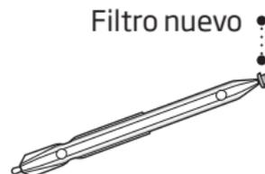
Extraiga la herramienta del embalaje. La herramienta tiene dos puntas: una para extraer y otra con el filtro O-Cap nuevo.
