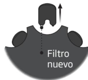
Extraiga la herramienta de la carcasa. La herramienta tiene dos puntas: una vacía para extraer y otra con el filtro ProWax mini nuevo.
