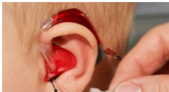
Aide auditive avec câble de programmation attaché et tube de mesure de l'oreille réelle in situ.
