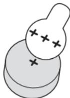
3. Placez la nouvelle pile dans le logement de pile. Assurez-vous que le marquage du côté positif (+) fait face au symbole positif (+) gravé sur le logement de pile.
