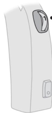
Utilisez la molette de commande de volume pour couper le son de l'appareil en la faisant tourner jusqu'en dessous du réglage 1 jusqu'à ce qu'elle clique. Pour réactiver l'appareil, tournez la molette de commande de volume dans l'autre sens.
