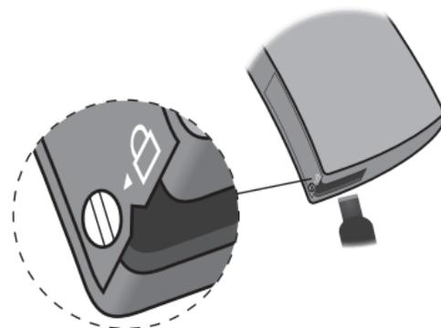
Utilisez le tournevis pour tourner la vis en position déverrouillée (verticale).
