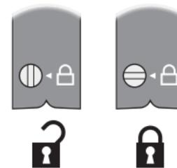
Assurez-vous que le logement de pile est entièrement fermé. Tournez la vis en position verrouillée (horizontale).
