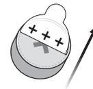
Remova a etiqueta adesiva do lado + da bateria nova.
